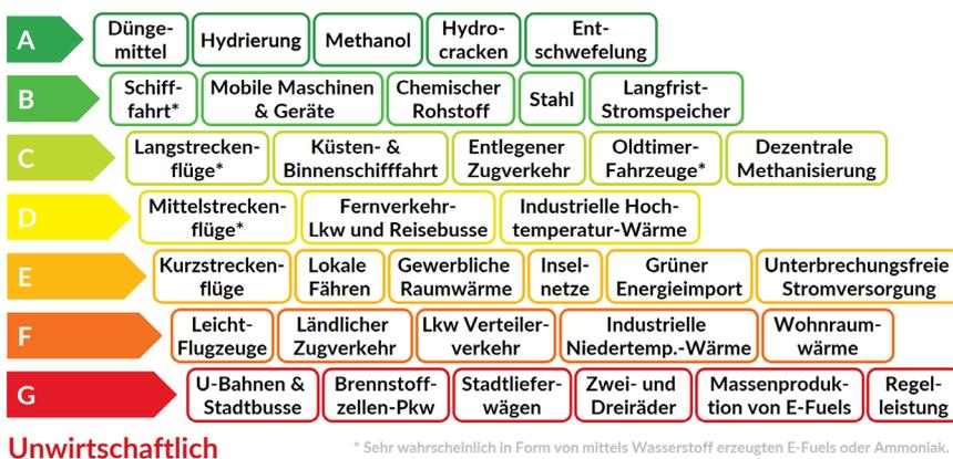
Die „Clean Hydrogen Ladder“ zeigt die sinnvollen Einsatzbereiche für Wasserstoff auf<sup>8</sup>. Hier wird die deutsche Übersetzung von Wikipedia gezeigt, angepasst an die neueste englische Version.
